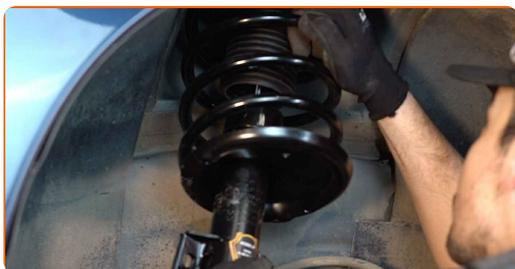
**39** Pieskrūvējiet augšējo amortizatora statņa balsta stiprinājumu. Nepievelciet to.
