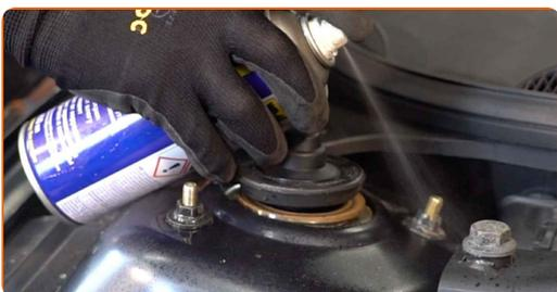
**4** Atskrūvējiet amortizatora statnes atbalstu augšējos stiprinājumus. Izmantojiet mucīņatslēgu Nr 13. Izmantojiet atslēgu ar tarkšķi.
