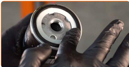
**17** Pieskrūvējiet jauno filtru tam paredzētajā vietā. Izmantojiet 76-14F uzgali. Izmantojiet dinamometrisko atslēgu. Griezies moments 18 Nm.
