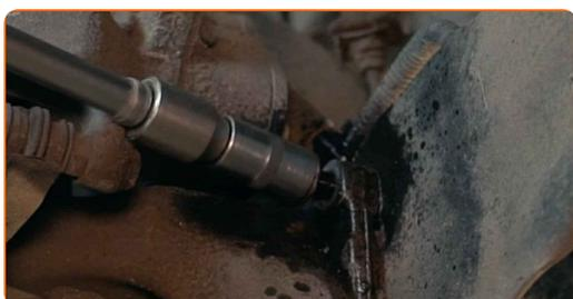
**8** Notīriet visus stabilizatora atsaites savienojumus. Izmantojiet metāla birsti. Izmantojiet WD-40 aerosolu.
