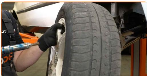
10 Notīriet skavas stiprinājumu, kas savieno bremžu šļūteni ar amortizatora statni. Notīriet amortizatora statnes stiprinājumus pie grozāmass. Izmantojiet metāla birsti. Izmantojiet WD-40 aerosolu.
