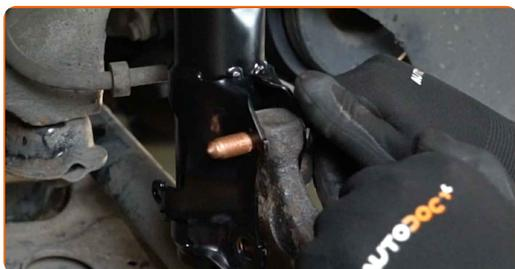
**43** Pieskrūvējiet stiprinājumus, kas savieno amortizatora statni ar grozāmasi. Izmantojiet kombinēto atslēgu Nr 18. Izmantojiet mucīņatslēgu Nr 18. Izmantojiet vītņurbja atslēgu.
