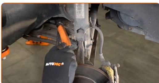
11 Atskrūvējiet bremžu šļūtenes stiprinājuma kronšteinu no amortizatora statņa. Izmantojiet mucīņatslēgu Nr 10. Izmantojiet atslēgu ar tarkšķi.
