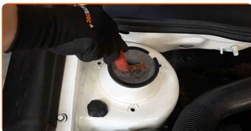
**4** Atskrūvējiet amortizatora statnes atbalstu augšējos stiprinājumus. Izmantojiet HEX Nr. H6. Izmantojiet mucīņatslēgu Nr 21. Izmantojiet atslēgu ar tarkšķi.
