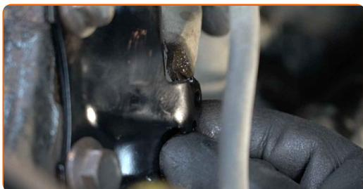
**41** Pievelciet bremžu šļūtenes stiprinājuma kronšteinu pie amortizatora statņa. Izmantojiet mucīņatslēgu Nr 10. Izmantojiet dinamometrisko atslēgu. Griezes moments 13 Nm.
