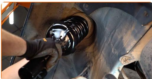
43 Pieskrūvējiet augšējo amortizatora statņa balsta stiprinājumu. Izmantojiet mucīņatslēgu Nr 13. Nepievelciet to.
