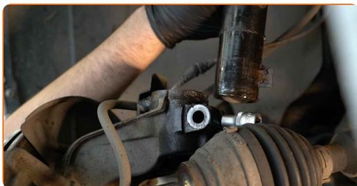
**28** Atskrūvējiet augšējo amortizatora statņa balsta stiprinājumu.
