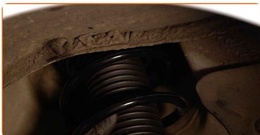
46 Pieskrūvējiet augšējo amortizatora statņa balsta stiprinājumu. Nepievelciet to.
