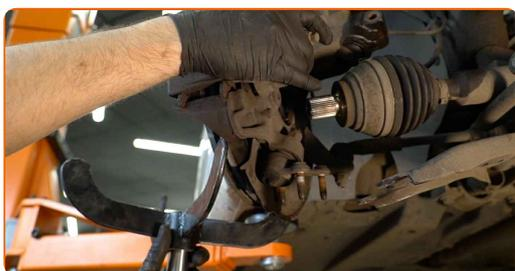
**26** Atlaidiet apakšējo stiprinājumu, kas savieno amortizatora statni pie grozāmass. Izmantojiet speciālu muciņu amortizatora demontāžai. Izmantojiet atslēgu ar tarkšķī.
