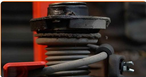
**32** Apstrādājiet amortizatora statnes kātu. Izmantojiet metāla birsti. Izmantojiet WD-40 aerosolu.
