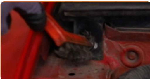
**4** Atskrūvējiet plastmasas paneļa stiprinājumus. Izmantojiet Torx T 30. Izmantojiet atslēgu ar tarkšķi.
