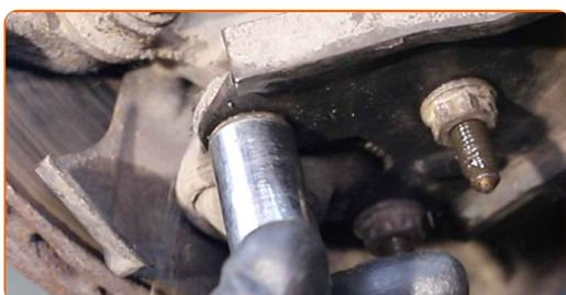
**69** Uzstādiet šķērsstabilizatora stiepni.
