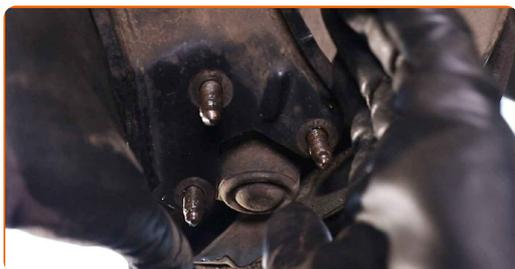
**68** Pievelciet stiprinājumus, kas savieno lodbalstu ar balstiekārtas sviru. Izmantojiet mucīņatslēgu Nr 16. Izmantojiet atslēgu ar tarkšķi.
