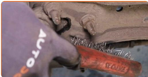
**26** Atskrūvējiet stiprinājumus, kas savieno lodbalstu ar balstiekārtas sviru. Izmantojiet mucīņatslēgu Nr 16. Izmantojiet atslēgu ar tarkšķi.
