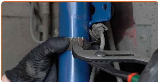
**64** Uzstādiet šķērsstabilizatora stiepi.
