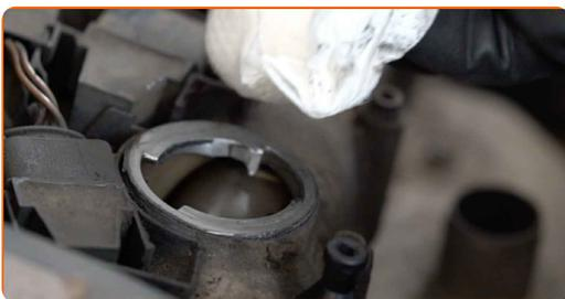
19 Uzstādiet eļļas iepildīšanas atveri. Aizskrūvējiet eļļas iepildīšanas atveri.
