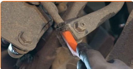
**9** Atskrūvējiet stiprinājumu, kas savieno stabilizatora atsaiti pie stabilizatora stieņa. Izmantojiet kombinēto atslēgu Nr 16. Izmantojiet XZN Nr. 6. Izmantojiet atslēgu ar tarkšķi.
