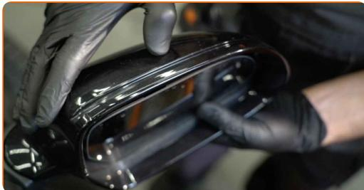
2 Uzmanīgi atbrīvojiet spoguļa stiklu no tā stiprinājuma. Izmantojiet plastmasas apdares demontāžas instrumentu.
