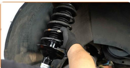
**32** Pieskrūvējiet augšējo amortizatora statņa balsta stiprinājumu. Nepievelciet to.
