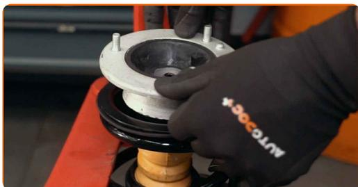
**39** Pievelciet amortizatora statņa klaņa uzgriezni. Izmantojiet mucīņatslēgu Nr 19. Izmantojiet HEX Nr. H6. Izmantojiet dinamometrisko atslēgu. Griezies moments 64 Nm.
