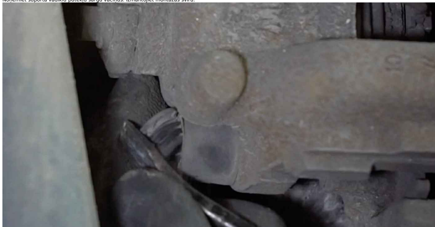
12 Atskrūvējiet bremžu suporta stiprinājumu. Izmantojiet HEX Nr. H7. Izmantojiet atslēgu ar tarkški.
