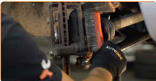
**13** Atskrūvējiet bremžu suporta kronšteina stiprinājumu. Izmantojiet Torx T 55. Izmantojiet vīturbja atslēgu.
