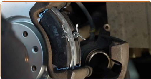
27 Uzstādiet bremžu suportu un piestipriniet to. Izmantojiet kombinēto atslēgu Nr 13. Izmantojiet kombinēto atslēgu Nr 15. Izmantojiet dinamometrisko atslēgu. Griezes moments 27 Nm.
